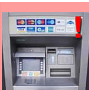
Bankomat z założonym nad wyświetlaczem "daszkiem", pod którym ukryta jest kamera skierowana na klawiaturę
